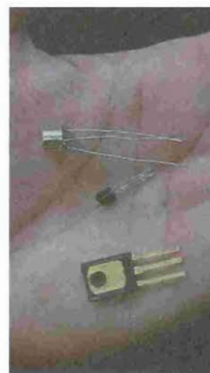
FIGURA 22.5 (a) Três transistores. (b) Muitos transistores em um circuito integrado.
