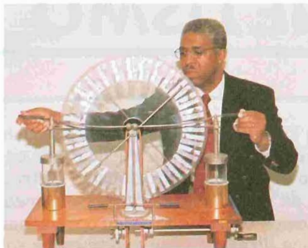
Jim Stith, antigo presidente da "American Association of Physics Teachers" (Associação Americana de Professores de Física), demonstra o funcionamento de um gerador de Whimhurst que produz relâmpagos em miniatura.
